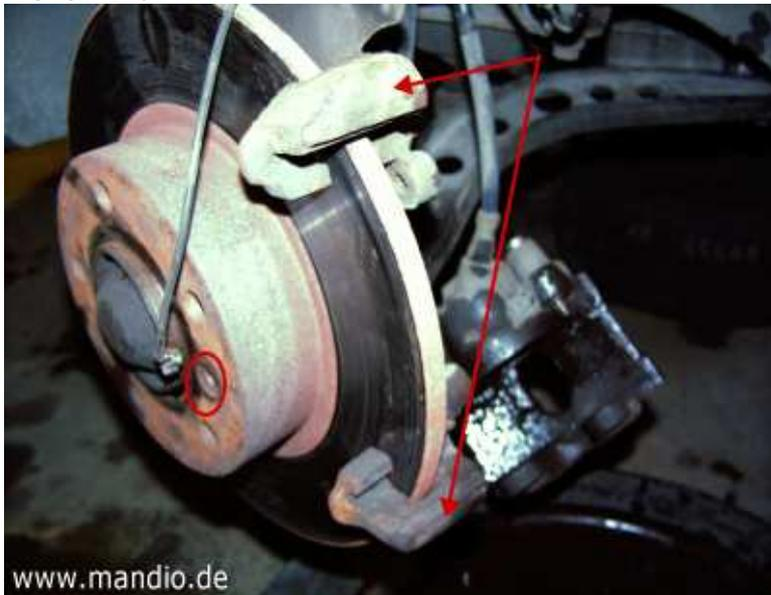
Der nächste Schritt ist das lösen des Bremssattels. Die Befestigung befindet sich gleich neben der zuvor gelösten Bremszange (siehe 2. Bild).
