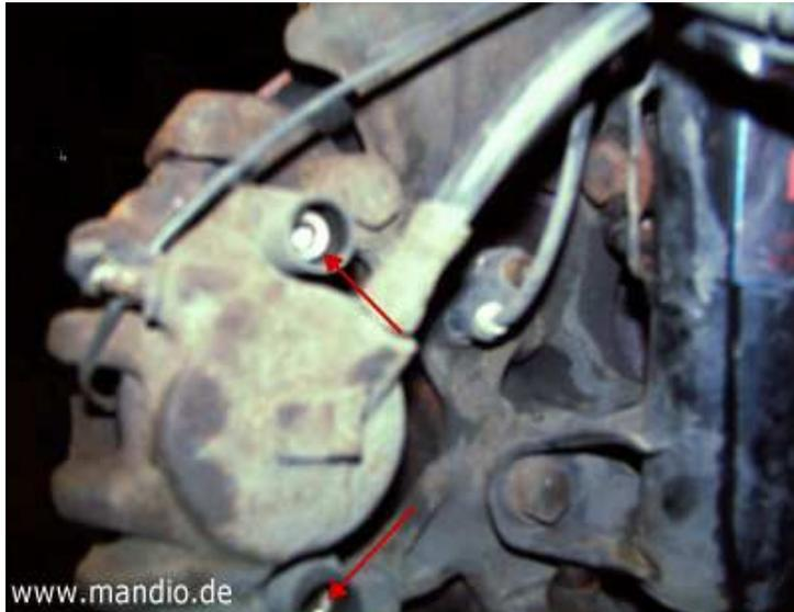
Die Bremszange könnt ihr zum Querlenker runterhängen lassen oder hochbinden. Reinigt die Bremszange gründlich mit Bremsenreiniger oder was vergleichbarem und macht den Bremszylinder wieder gangbar, falls er zu schwergängig läuft. Achtet auch auf die Staubschutzmanschette um den Kolben, die darf nicht beschädigt sein.
