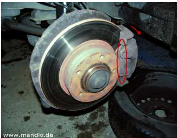
Jetzt müsst Ihr die Bremszange lösen, dazu schlagt ihr das Lenkrad ein, damit Ihr besser rankommt. Dort befinden sich zwei Plastikstöpsel die, die Schrauben vor Witterungen schützen. Die müssen nun mit dem 7er Sechskantschlüssel gelöst werden.
